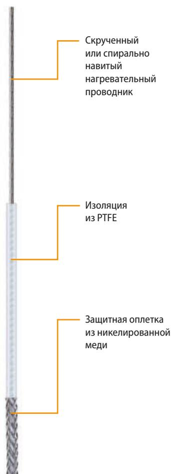
ELKM-AS применяется для обогрева механизмов, резервуаров, трубопроводов, клапанов и т. д., где небольшой радиус изгиба позволяет плотно прокладывать кабель по всей поверхности, в том числе на маленьких деталях. Нагревательный кабель ELKM-AS с защитной оплеткой АЕ применяется для незащищенного использования в коррозионной среде, также доступен без защитной оплетки под наименованием ELKM-A.
